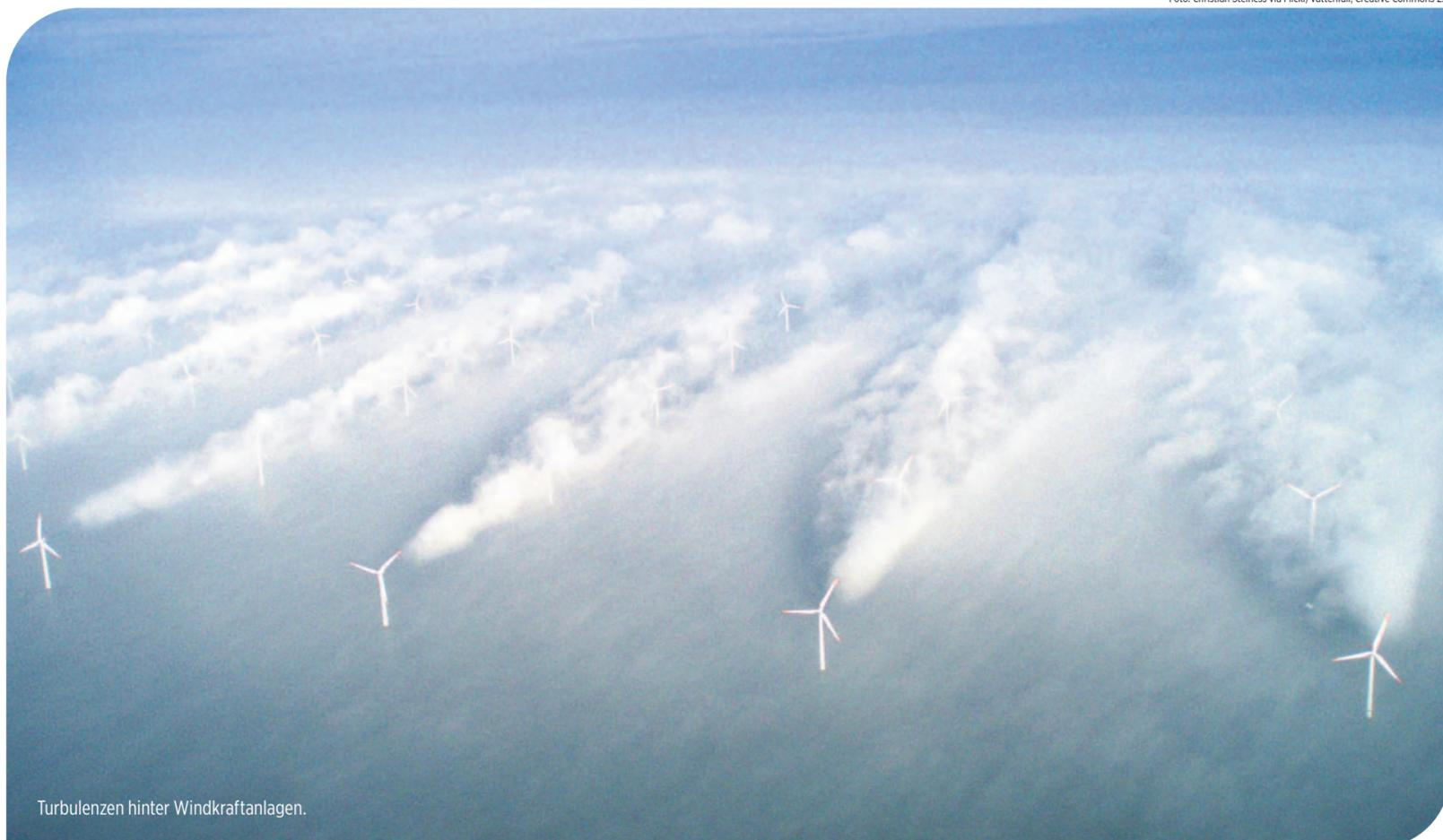
Turbulenzen hinter Windkraftanlagen.
